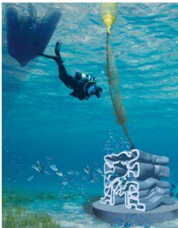
Principe d'écoconception d'un corps-mort (impression béton 3D) et d'équipement d'une ligne de mouillage par des habitats artificiels type « Roselière® » (© Seabost)
